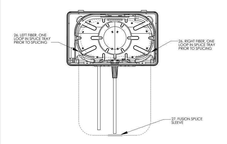
26. STOW ONE LOOP OF EACH FIBER IN THE SPLICE TRAY. TAKE EACH FIBER END OUT OF THE SPLICE TRAY.
