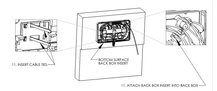
11. INSERT TWO CABLE TIES PRIOR TO ATTACHING THE BACK BOX INSERT INTO THE BACK BOX. ATTACH THE BACK BOX INSERT INTO THE BACK BOX SO THAT THE TWO BACK BOX LATCHES SNAP ONTO THE TWO BACK BOX INSERT CATCHES. IF BOTH CABLES ENTER THE MODULE THROUGH THE BOTTOM SURFACE OF THE BACK BOX, THEN ATTACH THE BACK BOX INSERT INTO THE BACK BOX WITHOUT THREADING THE FIBERS.
