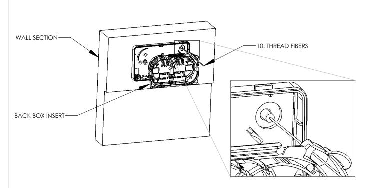
10. IF A CABLE ENTERS THE BACK BOX THROUGH ITS BACK SURFACE, THEN THREAD THE FIBERS THROUGH THE HOLE IN THE BACK BOX INSERT.
