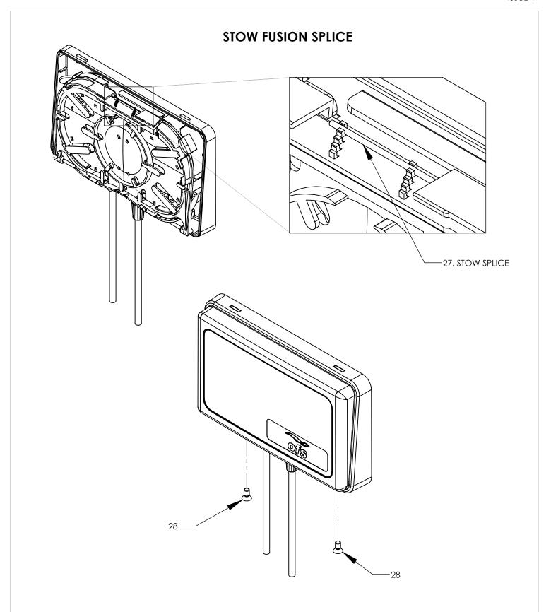
27. STOW THE COMPLETED SPLICE IN THE SPLICE HOLDER LOCATED AT THE TOP OF THE SPLICE TRAY.
